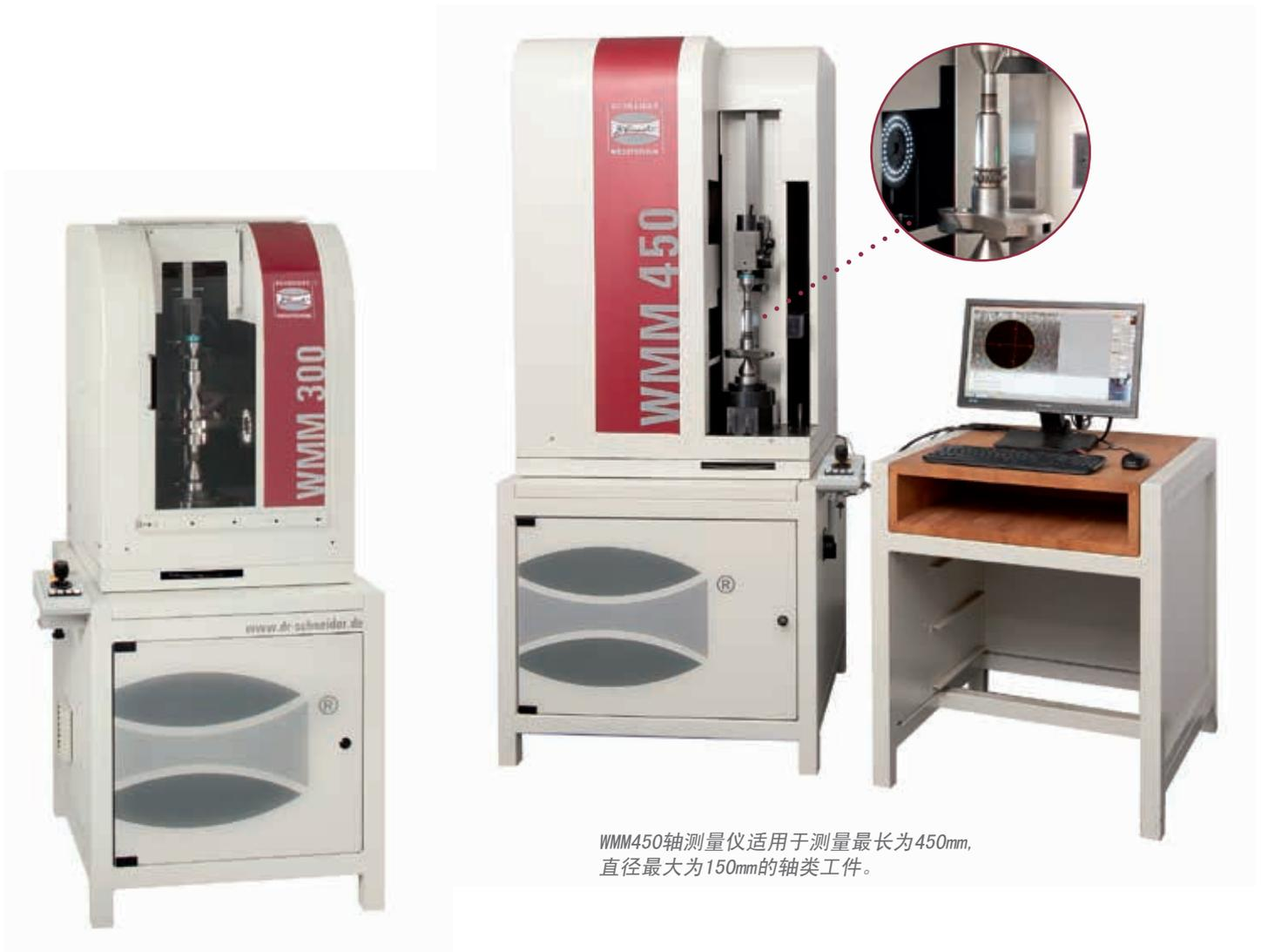
WMM450轴测量仪适用于测量最长为450mm、直径最大为150mm的轴类工件。
